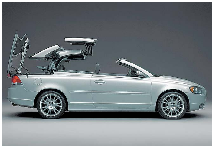
Ein reizvolles Angebot: das vierplätzig Volvo-Cabriolet C70 mit dem dreiteiligen, versenkbaren Hardtop.
